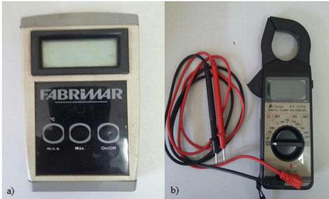
Figura 4. a) Manômetro digital e b) Multímetro digital.
