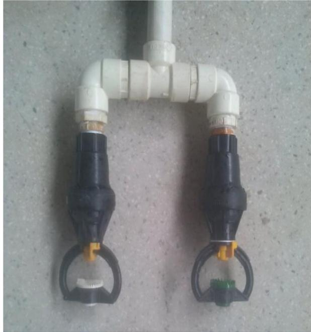
Figura 2. Regulador de pressão associado aos bocais emissores.
